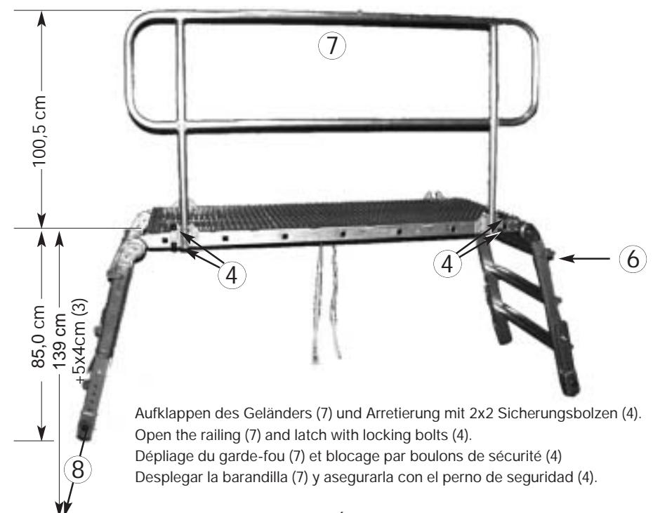
Aufklappen des Geländers (7) und Arretierung mit 2x2 Sicherungsbolzen (4).
