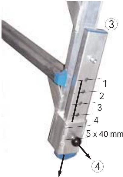
Einzelfußverstellung (3) max. 5 x 50 mm durch Ent- und Verriegeln der Sicherungsbolzen (4).
